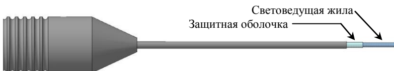
Положение рабочего торца световода в ручке при проверке и работе
